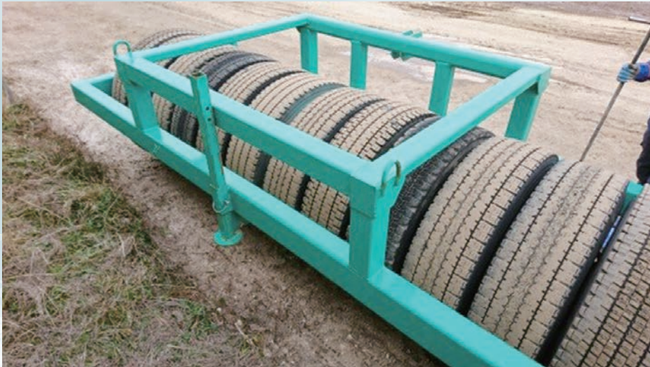
雪踏みローラー（写真はロアリンクに取付けるタイプ。牽引式もある）
